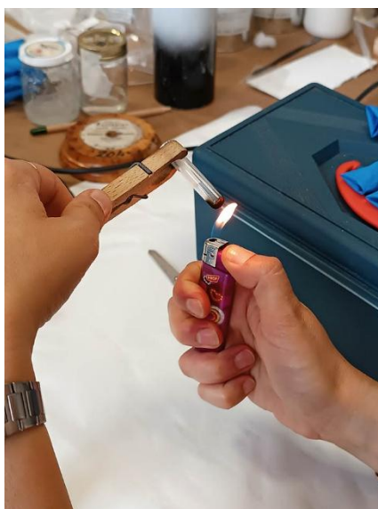
Fig. 119 Apporto di calore alla micro-provetta contenente la striscia di carta impregnata.
