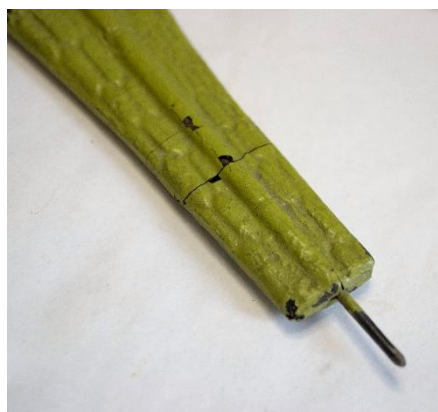
Fig. 53 Crettature da essiccamento della preparazione resinosa.
