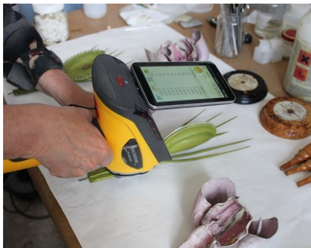
Fig. 102 Ripresa sull' Aldrovanda vesiculosa Linn con l'analizzatore XRF.
