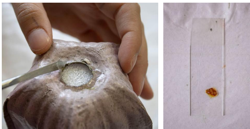
Fig. 124 e 125 A sinistra, prelievo del campione di adesivo vinilico. A destra, risultato del test, con esito positivo.
