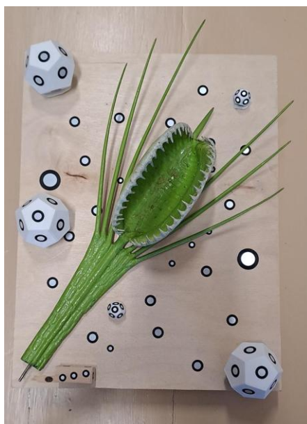
Fig. 229 Posizionamento dei target sul piano rotante.
