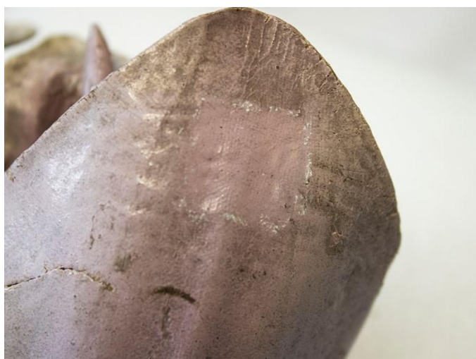
Fig. 174 Tassello di pulitura a seguito dell'applicazione di Velvesil Plus addizionato con White Spirit.
