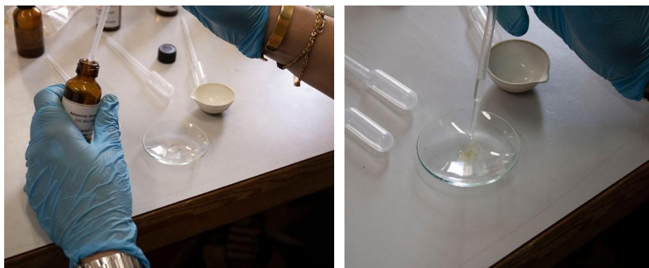
Fig. 122 e 123 Fasi del riconoscimento di oli siccativi all'interno degli strati pittorici.
