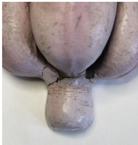
Fig. 67 Accavallamento delle parti di preparazione
