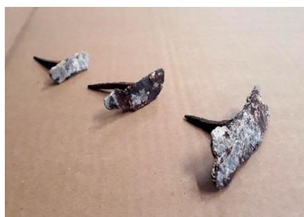
Fig. 54-55 Chiodi a testa larga in ferro battuto. La dimensione della testa varia a seconda di quanto supporto deve esercitare.
