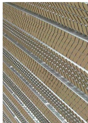
Fig. 83 Nervometal portaintonaco in ferro zincato (foto dal web).
