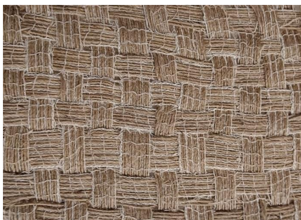
Fig. 91 Intreccio con tessuto naturale di juta rinforzata con fibre sintetiche.
