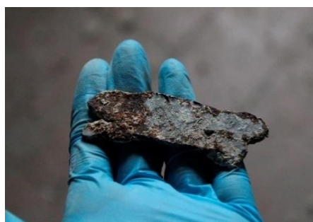
Fig. 54-55 Chiodi a testa larga in ferro battuto. La dimensione della testa varia a seconda di quanto supporto deve esercitare.
