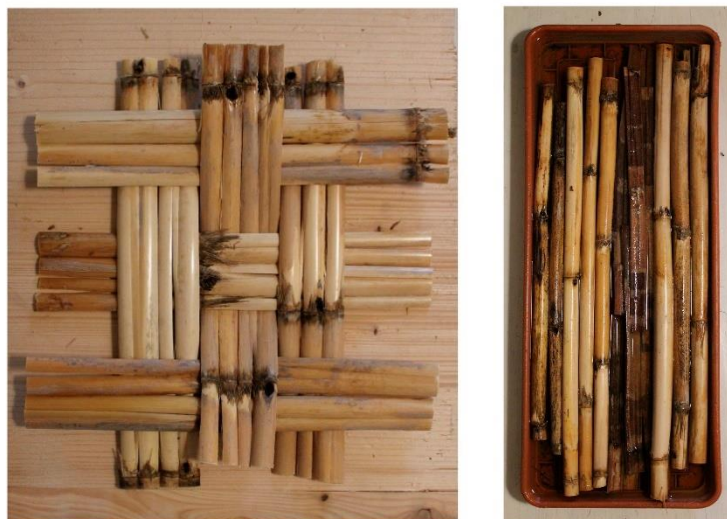
Fig. 48-49 Test d'intreccio con canne secche. A destra le canne sono a bagno per aumentare la loro flessibilità.
