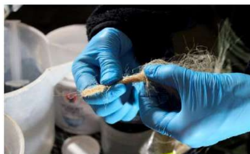
Fig. 131 Preparazione del perno con stoppa e Acril 33 .
