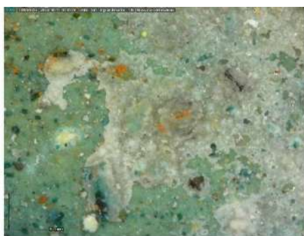
Fig. 106 Fotografia il microscopio ottico portatile delle ricarbonatazioni.
