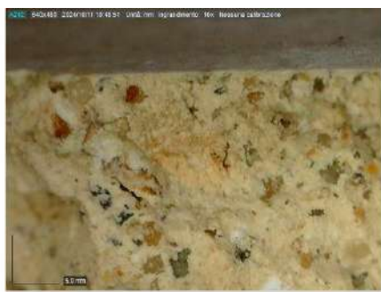
Fig. 60 Immagine al microscopio ottico portatile dello strato d'intonachino
