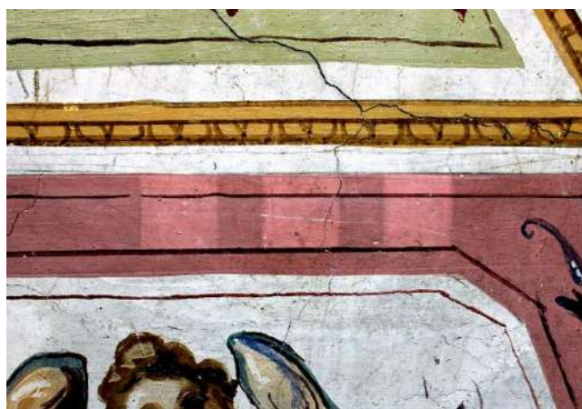
Fig. 125 Test del mezzo per la pulitura dei depositi e residui di Paraloid (a sinistra-cotone a tampone; al centro-cotone e garza; a destra-spugna).
