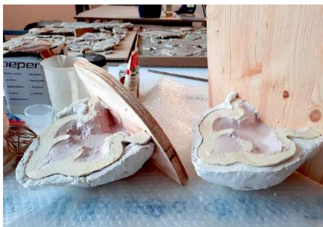
Fig. 189 Stampo in silicone per realizzare le copie del pinnacoli in legno andati persi.
