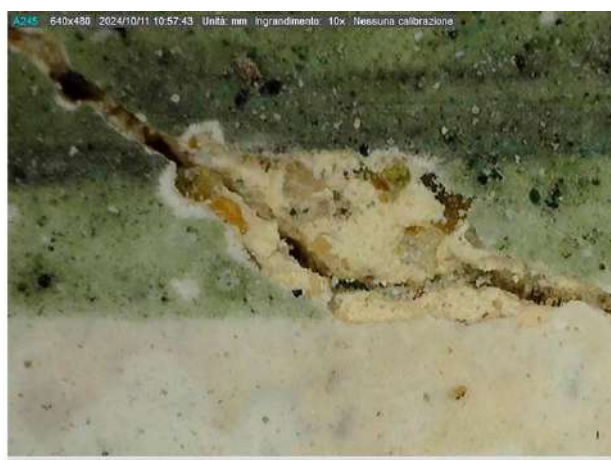
Fig. 80 Immagine scattata con microscopio ottico portatile del colore sovrapposto all'intonaco.
