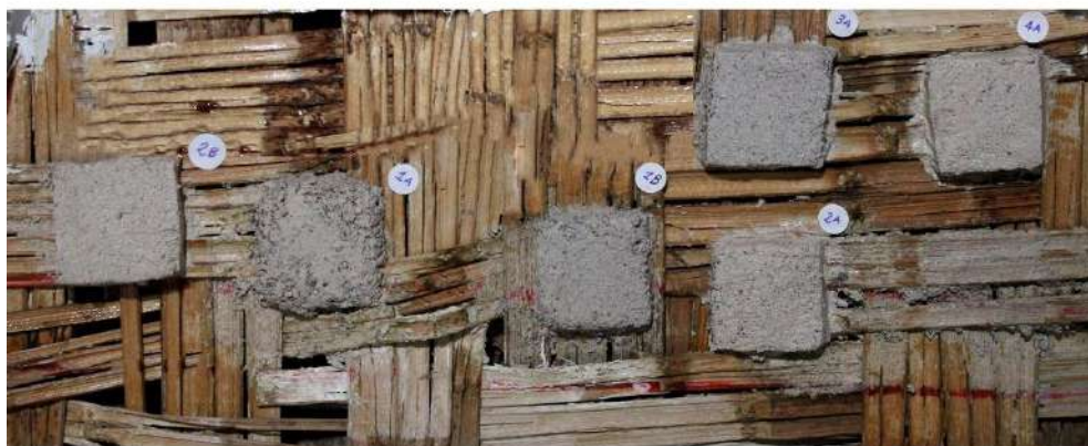
Fig. 171 Provini della malta alleggerita per l'arriccio.
