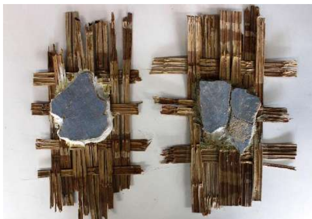
Fig. 151 Prove per la scelta della malta d'adesione dei frammenti al canniccio (a destra-malta idraulica; a sinistra-Ledan ITAL B2).
