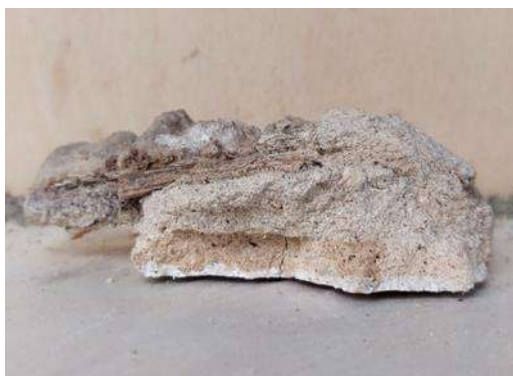
Fig.62 Stratigrafia di un frammento rinvenuto dal crollo
