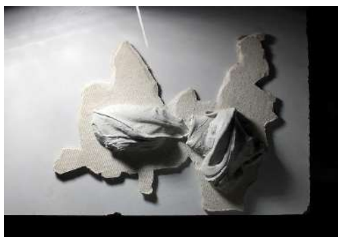
Fig. 162 Applicazione di uno strato di Ledan sul retro del frammento.
