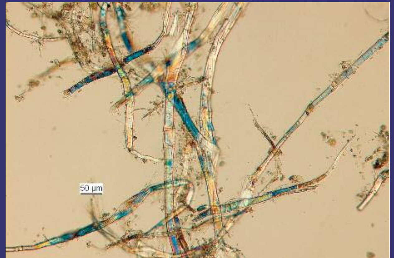
18. Campione di cartapesta: fibre di lino e di canapa al microscopio ottico in luce parzialmente polarizzata
