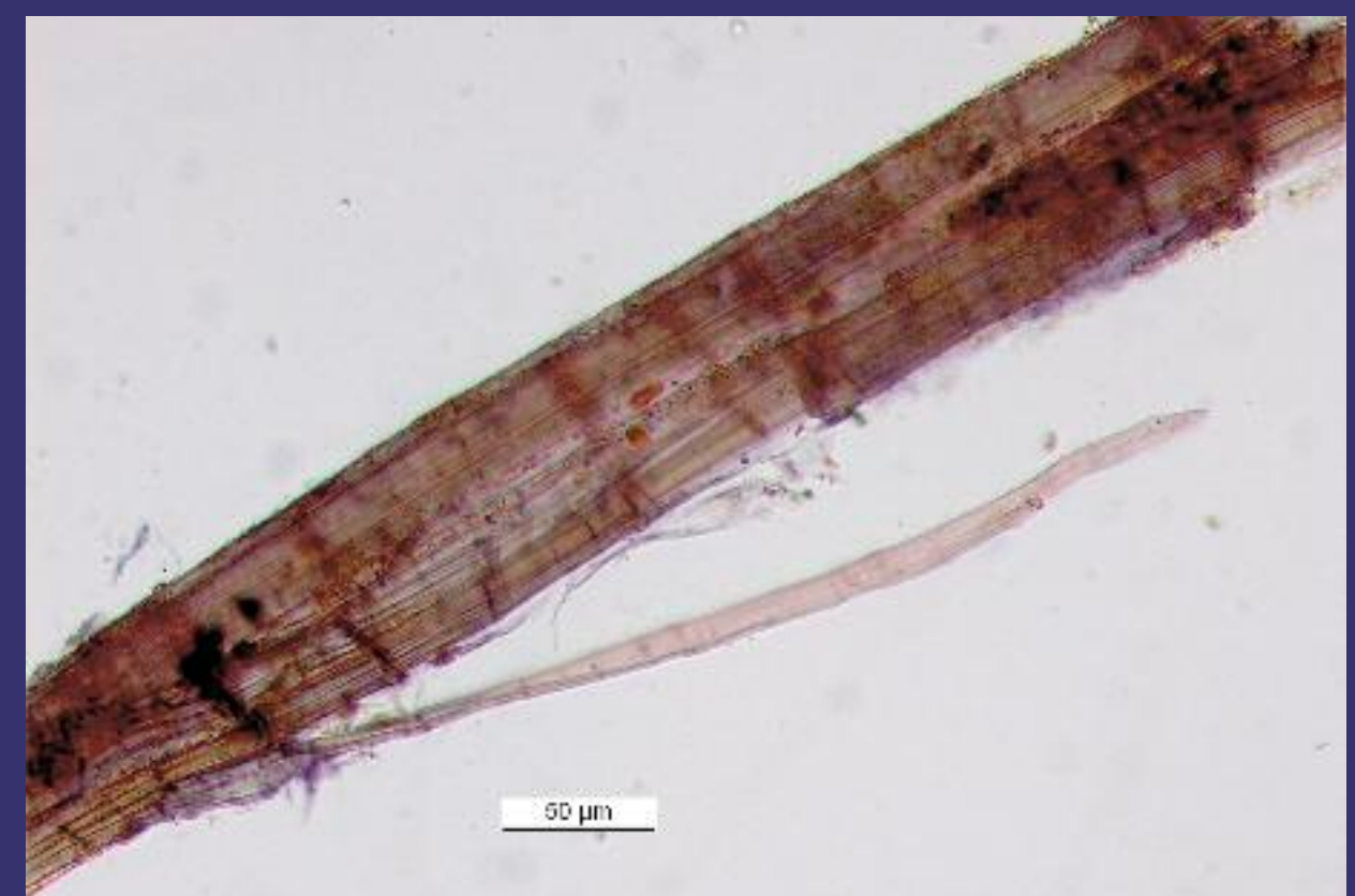
19. Fascio di fibre di canapa trattate con reattivo di Herzberg
