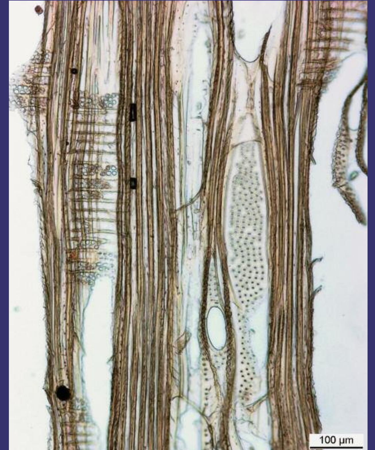
22. Sezione longitudinale radiale al microscopio ottico in luce trasmessa
