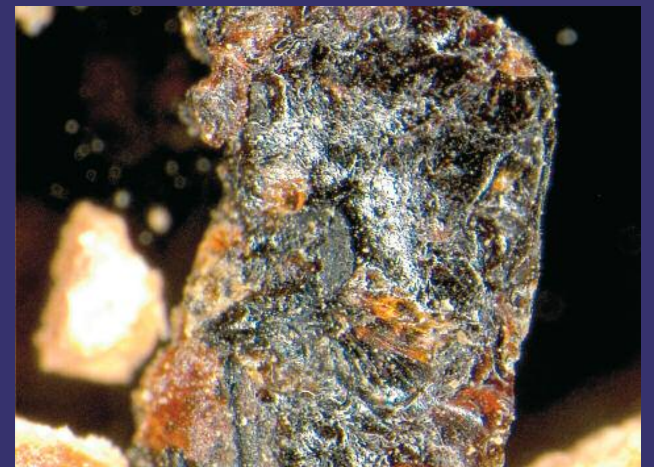
24. Microfotografia di un particolare della colofonia, parzialmente scurita dal trattamento termico (ingr. 63X)
